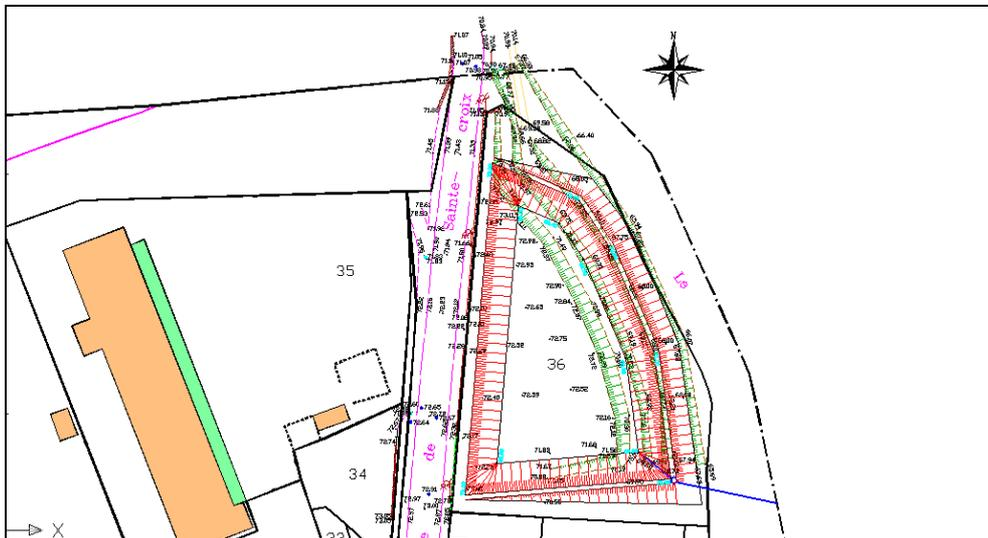
Esquisse d'implantation d'un bassin de régulation des eaux pluviales
